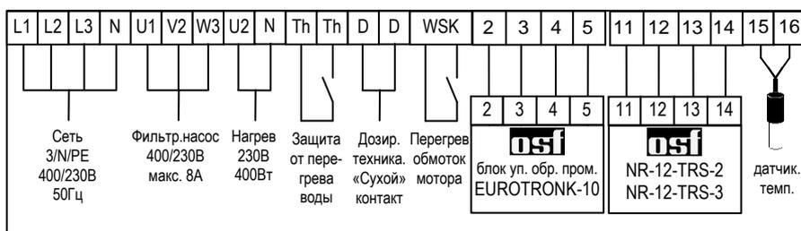
Электронный регулятор точно регулирует температуру воды в бассейне. Нагрев можно отключить из меню. Датчик температуры с кабелем 1,5 м. входит в поставку.
